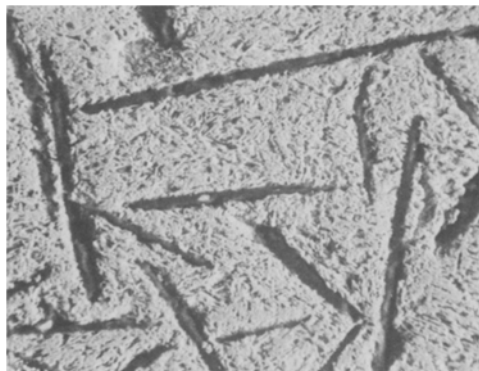
Abb. 1. REM-Aufnahme von \text{Mo}_{0,39}\text{W}_{0,025}\text{Co}_{0,019}\text{C}_{0,566} , geblüht 1100 h bei 950^\circ\text{C} (Vergrößerung: 200fach): Graphitlamellen in Matrix aus (\text{Mo,W})\text{C}_{\text{hex}} und etwas (\text{Mo,W})_2\text{C}
